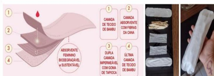
Figura 2 – Composição do absorvente produzido com bagaço de cana produzido pela turma de iniciação científica do "GARCIA". (FONTE: Registro dos autores do projeto.)
